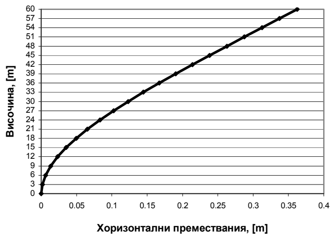
Фигура NA.3.6.5 - Хоризонтални премествания на приложните точки на масите при натоварване със силите от фигура NA.3.6.4
